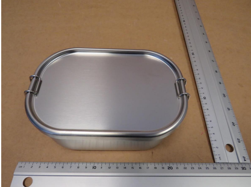
Bild / Picture 1: Edelstahl-Lunchbox PURO mit SecureLock360°-Verschlussystem, 1250 ml / Stainless steel lunch box PURO with SecureLock360° closure system, 1250 ml
